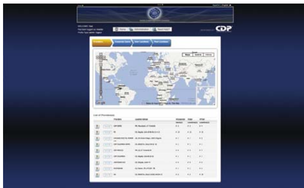
Monitoreo efectuado a través del display interactivo del UPS, desde un computador conectado a la unidad o desde cualquier parte del mundo
